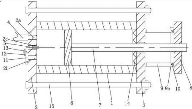
这项发明的这样介绍“本发明公开一种便携式多功能生物撞击机。本发明通过可燃气体燃烧产生的压力来推动所述活塞移动，与传统结构通过电磁阀控制压缩空气来推动一次锤撞击二次锤有本质的区别，不用自带笨重的气泵，因此本发明结构简单、紧凑，响应速度快，易实现便携，并且本撞击机可根据需要选择加速度曲线，具有一机两用的功能，具有创造性和很好的实用性，还能基于本生物撞击机获取撞击能量”。
