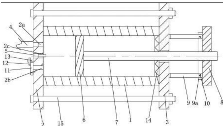
這項發明的這樣介紹「本發明公開一種便攜式多功能生物撞擊機。本發明通過可燃氣體燃燒產生的壓力來推動所述活塞移動，與傳統結構通過電磁閥控制壓縮空氣來推動一次錘撞擊二次錘有本質的區別，不用自帶笨重的氣泵，因此本發明結構簡單、緊湊，響應速度快，易實現便攜，並且本撞擊機可根據需要選擇加速度曲線，具有一機兩用的功能，具有創造性和很好的實用性，還能基於本生物撞擊機獲取撞擊能量」。
